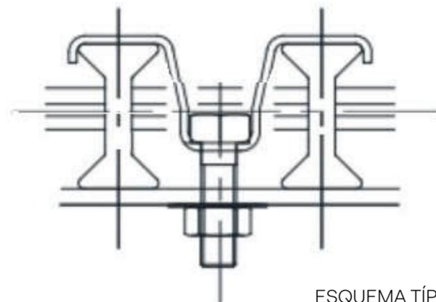
ESQUEMA TÍPICO DE FIJACIÓN
